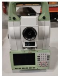
Hình 5. Chuẩn công tác: Máy toàn đạc điện tử chuẩn có độ chính xác đo dài \leq(4+3.10^{-6}.D) mm
