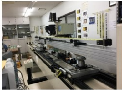
Hình 3. Ví dụ về hệ thống cho hiệu chuẩn thước mìa
